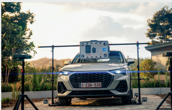
Le panneau de calibration constitue le point de référence visuel à l'aide duquel la caméra du véhicule est réalignée.
